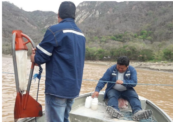
Muestreo de Sedimentos en suspensión y de Arrastre de Fondo en Paraíso – río Grande (Proyecto Hidroeléctrico Rositas)
